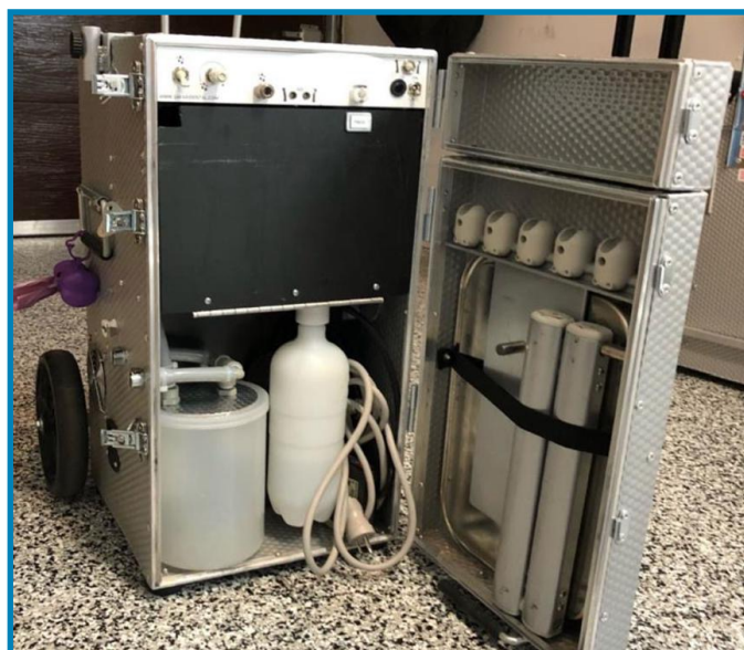
La caisse en aluminium contient le compresseur, les réservoirs d'eau propre et/ou usée reliés aux pièces à main et à l'aspirateur, ainsi qu'un plateau mobile.
