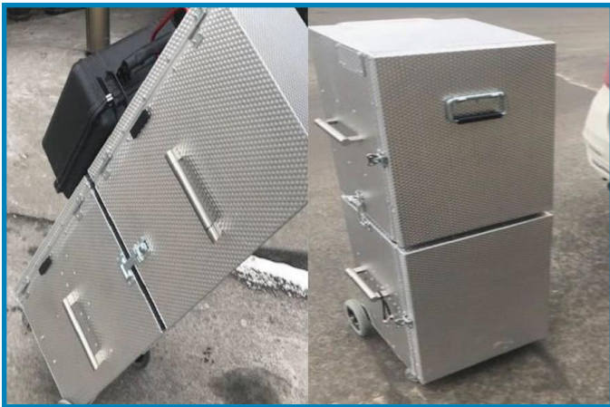
Fig. 2 - Unité de traitement dentaire portative sur mesure.
