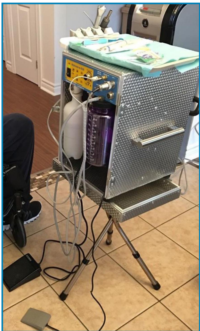
Fig. 5 - Unité de traitement portable sur mesure, peu encombrante, servant à faire les visites à domicile.
